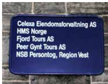
Skilt med hvite bokstaver på mørk blå bakgrunn har god lesbarhet. Kontrasten mellom skiltet og veggen bak er derimot dårlig. Jernbanestasjonen i Bergen. Foto: Ingfrid Bækken, Bergen Byarkiv.
