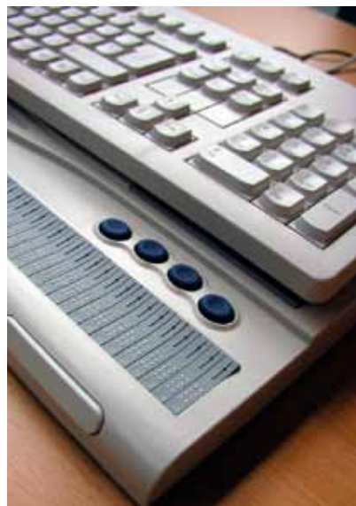
En leselist plasseres foran eller under tastaturet og viser teksten på skjermen i punktskrift. Foto:
